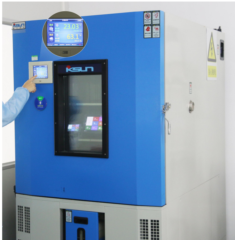
图 4-7 高低温老化测试图
